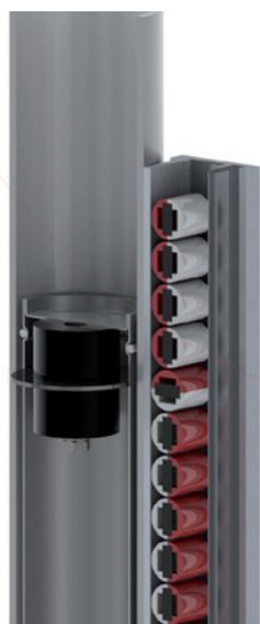
В байпасной трубе расположен цилиндрический поплавок со встроенной магнитной системой. Концентрированное магнитное поле постоянного магнита точно соответствует уровню жидкой среды в байпасе. Бесконтактным методом оно передается по стенкам вертикальной трубы на установленные снаружи элементы отображения, записи и переключения.
