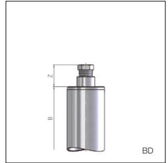
Крышка трубки с заглушкой вентиляционного отверстия NPT..
