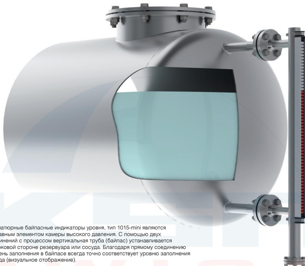
Миниатюрные байпасные индикаторы уровня, тип 1015-mini являются составным элементом камеры высокого давления. С помощью двух соединений с процессом вертикальная труба (байпас) устанавливается на боковой стороне резервуара или сосуда. Благодаря прямому соединению уровень заполнения в байпасе всегда точно соответствует уровню заполнения сосуда (визуальное отображение).
