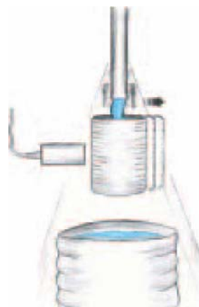
Рис. 2: Контроль позиционирования транспортируемых жестяных крышек
