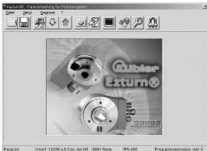
Ezturn представляет собой инструмент для программирования многооборотных датчиков Kübler нового поколения. Все эти датчики являются программируемыми. Датчики поставляются с приведенными в технической документации установками по умолчанию. С помощью комплекта для программирования пользователь может запрограммировать любой такой датчик.
