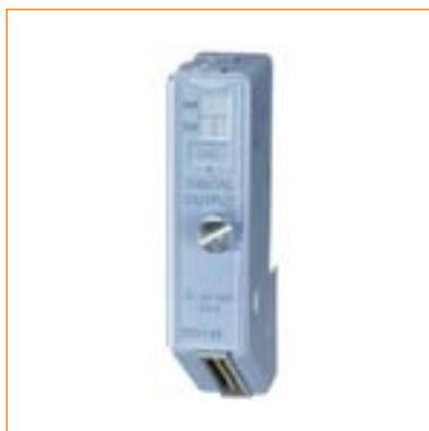
Электрически изолированный 8-канальный цифровой выходной модуль DO139 можно подсоединить как сторону высокого или низкого напряжения, а также как двухтактный выход для управления двигателями постоянного тока с номинальным напряжением 12 – 24 В пост. тока и номинальными токами до 0.5 А.
