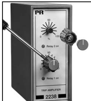
Billede 2: Afmontering af knapper.
