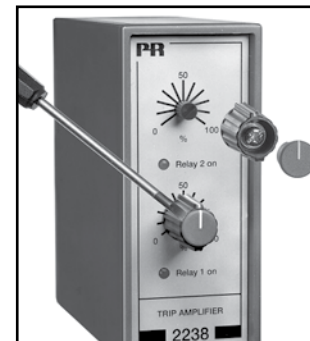
Abb.2: Entfernen von Drehknöpfen.
