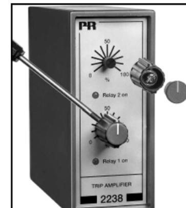
Рис. 2: Снятие поворотных ручек
