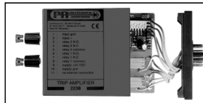
Рис. 3: Извлечение платы для изменения положений переключателей и перемычек
